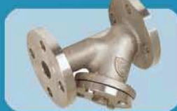
Filtros en Y Roscado/Bridado Cuerpo en fundición gris GG25 o acero inox, AISI 316 Tamiz en acero inox, AISI304
