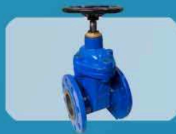
Válvulas de compuerta de cierre elástico Cuerpo en Fundición nodular GGG-50 Husillo fijo o ascendente
